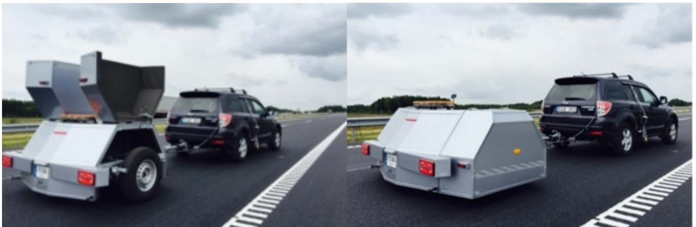
Padangos ir dangos kontakto sukeliama triukšmo lygio matavimo įranga CPX transportavimo (kairėje) ir matavimo (dešinėje) metu
